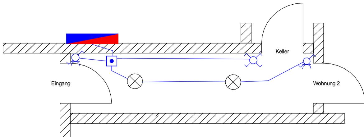
14. Beschriften Sie im oben abgebildeten Plan sämtliche Rohre mit den enthaltenen Drähten inklusive den Drahtfunktionen. (z.B. 3x1,5 LNPE).
